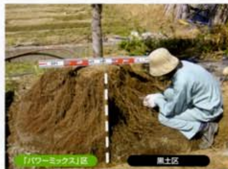
植物の根は「パワーミックス」工法を選びました。
